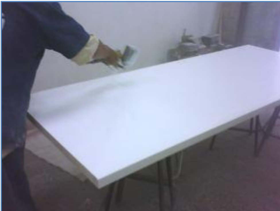
Fig. 42 Aplicación de primer y esmalte.
