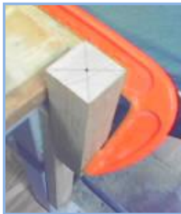
Figs. 32 y 33 Trazo y marca en la punta de la espuela.
