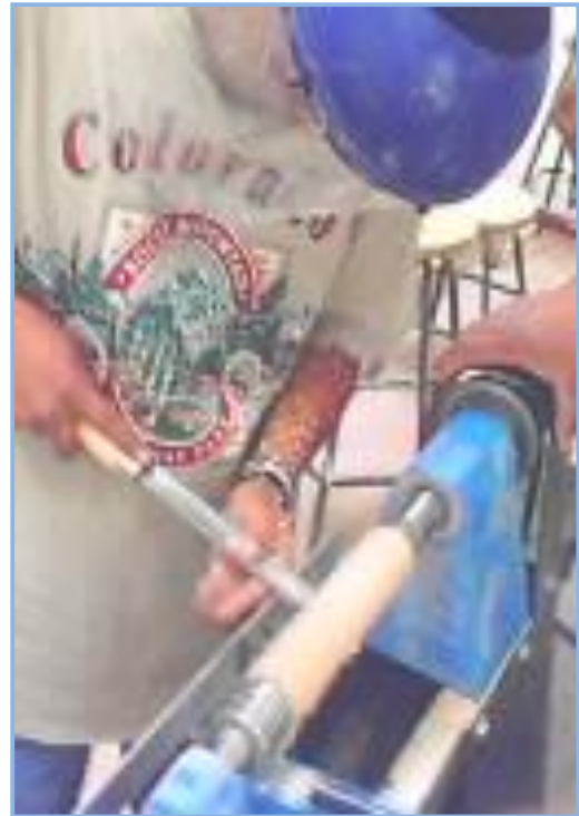
Fig. 19 Método de raspadura.
