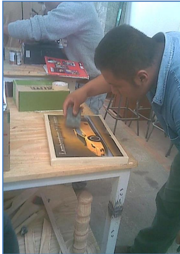
Fig. 46 Aplicación de resina epóxica.
