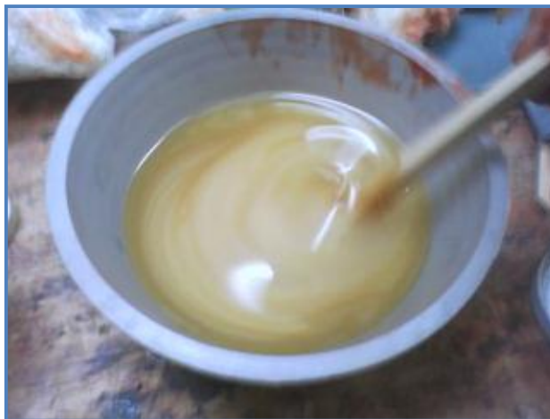
Fig. 8 Disolución de sellador con diluyente.
