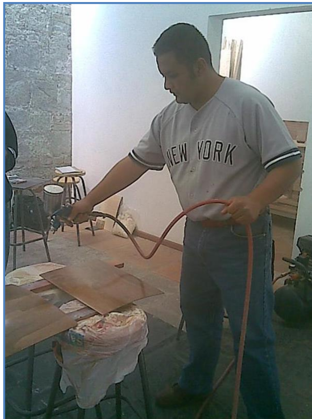
Fig. 44 Aplicación de tinta al alcohol con poliuretano.
