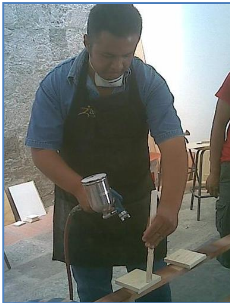
Fig. 41 Aplicación de tinta barniz marino.
