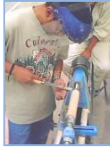
Figs. 65, 66 y 67 Ranurado con fresa partidora.
