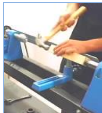
Figs. 34 y 35 Colocación y fijado de la pieza.
