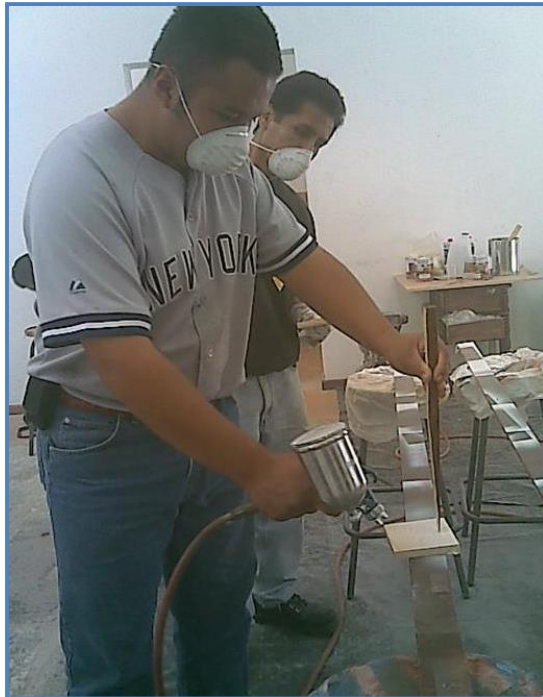
Fig. 40 Aplicación de sellador y laca mate.
