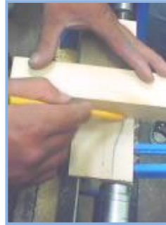
Figs. 60, 61 y 62 Transferencia del trabajo a las plantillas.
