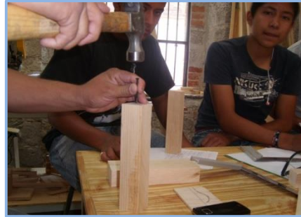
Fig. 25 Fabricación de guía con lanceta.
