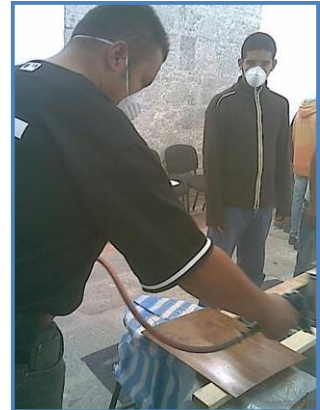
Fig. 37 Aplicación de laca brillante base nitrocelulosa.
