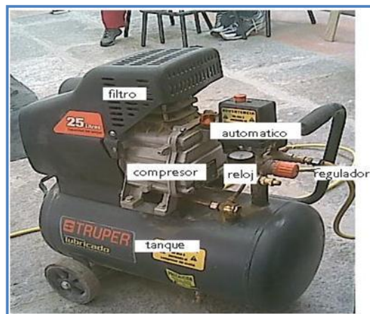
Fig. 9 Partes de una compresora.
