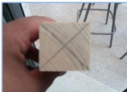
Fig. 24 Trazo en el centro de la pieza.
