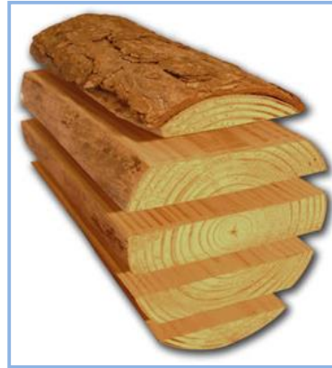
Figs. 5 y 6 Cortes en cuartos y basto.
